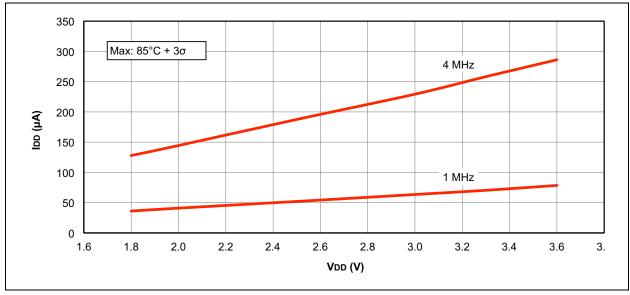
FIGURE 22-5: IDD TYPICAL, EC OSCILLATOR, HIGH-POWER MODE
