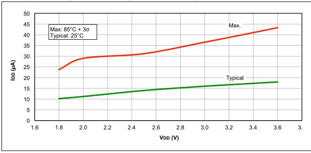
FIGURE 22-3: IDD TYPICAL, EC OSCILLATOR, MEDIUM-POWER MODE,
