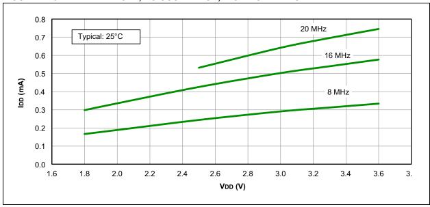
FIGURE 22-6: IDD MAXIMUM, EC OSCILLATOR, HIGH-POWER MODE
