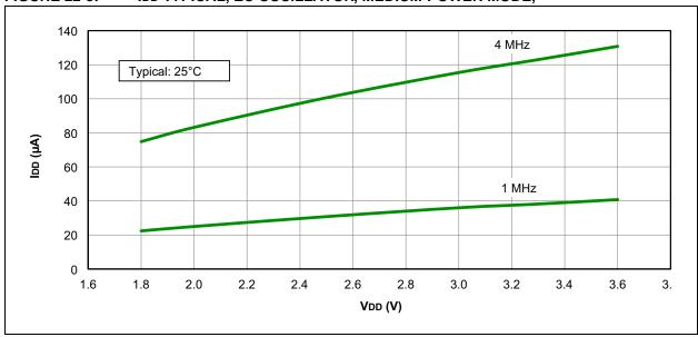
FIGURE 22-4: IDD MAXIMUM, EC OSCILLATOR, MEDIUM-POWER MODE
