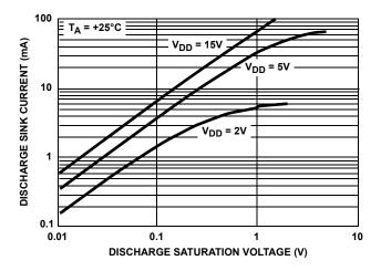
FIGURE 15. DISCHARGE OUTPUT CURRENT vs DISCHARGE OUTPUT VOLTAGE
