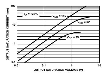
FIGURE 16. OUTPUT SATURATION CURRENT vs OUTPUT SATURATION VOLTAGE
