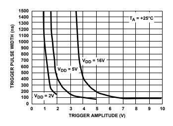
FIGURE 10. MINIMUM TRIGGER PULSE WIDTH vs TRIGGER AMPLITUDE
