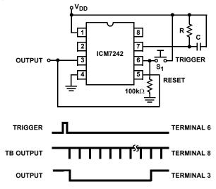
FIGURE 4. MONOSTABLE OPERATION
