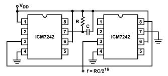
FIGURE 3. LOW FREQUENCY REFERENCE (OSCILLATOR)
