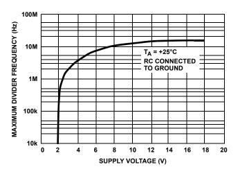
FIGURE 14. MAXIMUM DIVIDER FREQUENCY vs SUPPLY VOLTAGE
