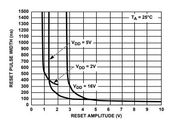
FIGURE 11. MINIMUM RESET PULSE WIDTH vs RESET AMPLITUDE
