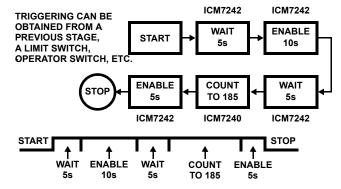
FIGURE 5. FLOW CHART FOR MACHINE TOOL CONTROLLER
