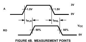
FIGURE 4. RECEIVER PROPAGATION DELAY
