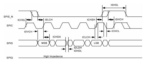
Figure 28. SPI Input Timing
