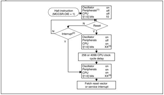
Figure 27. Active-halt mode flowchart
