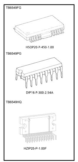
Weight HSOP20-P-450-1.00: 0.79 g (typ.) DIP16-P-300-2.54A: 1.11 g (typ.) HZIP25-P-1.00F: 7.7g (typ.)
